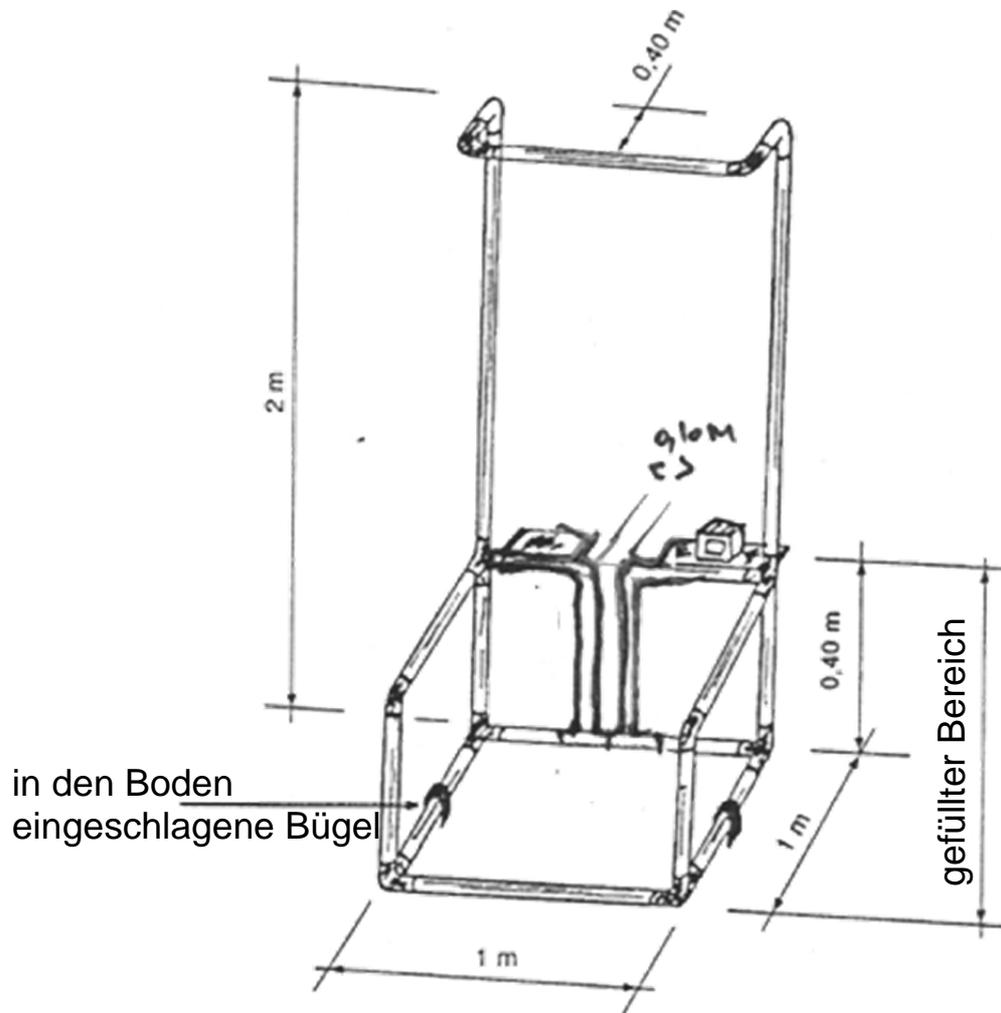
Bereich zur Schussabgabe aus farbigen PVC-Rohren, D=50 mm, gerade Rohre und Bögen der ganze untere Bereich sollte mit Wasser oder Sand gefüllt sein oder im Boden befestigt sei
