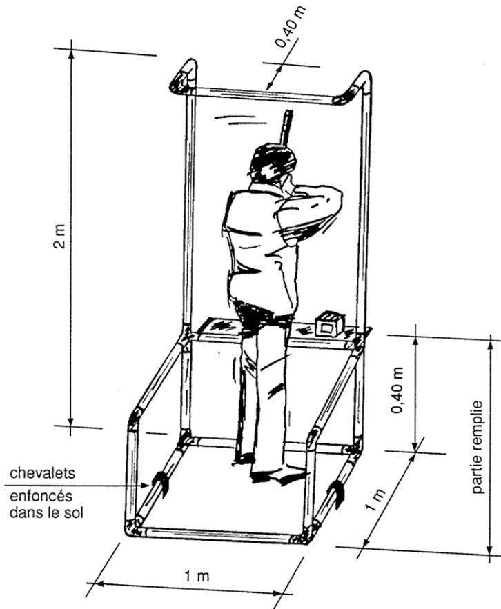
Bereich zur Schussabgabe aus farbigen PVC- Rohren, D=50 mm,
